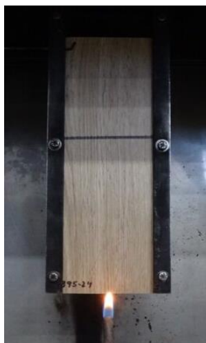
Fotografia 3 – Ensaio com o queimador aplicado na borda do corpo de prova.
